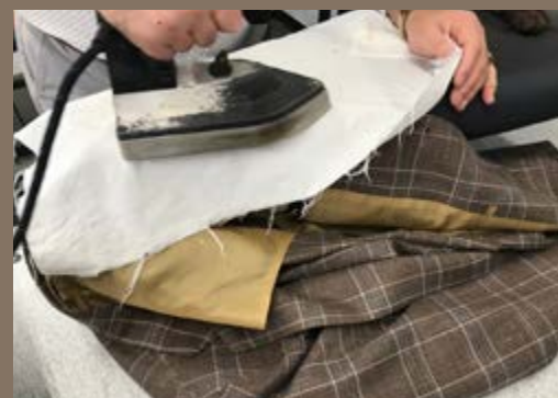
I pacchetti di tessuto, tagliati a mano, pronti per diventare giacche. Lo stiro è un passaggio fondamentale per conferire al capo il carattere finale
