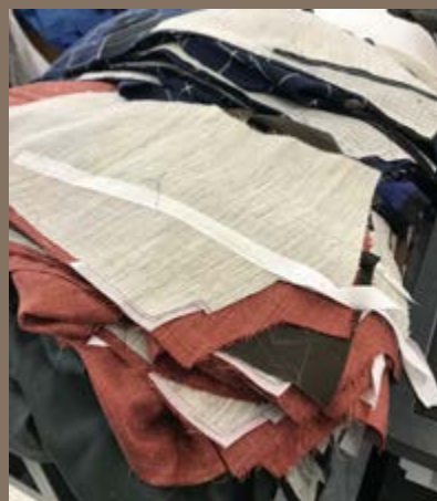
I pacchetti di tessuto, tagliati a mano, pronti per diventare giacche. Lo stiro è un passaggio fondamentale per conferire al capo il carattere finale
